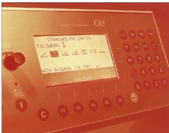
你拥有放大的多功能的控制面板：在这里可以显示故障信息、可以进行切换长度计量单位等所有操作。
