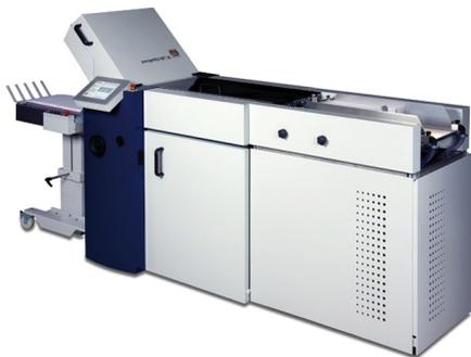
prestigeFOLD NET 38/6 底部吸风输入、顶部不停机加载的 PBA
