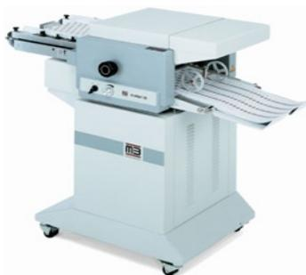
multipli 35 S 底部吸气输入，顶部不停机加载
