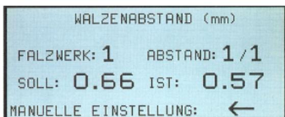
不再需要熟悉如何计算和调整轴间隙的知识，CAS控制中心根据测量的物料厚度和折纸类型计算出最佳的轴间隙，通过简单地调整折纸部分相应间隙调节旋钮把相应的折纸滚轴间隙调整到参考值即可。
